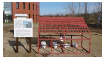
乾燥地研究センターにおける樹脂を含浸した砂岩の暴露試験
